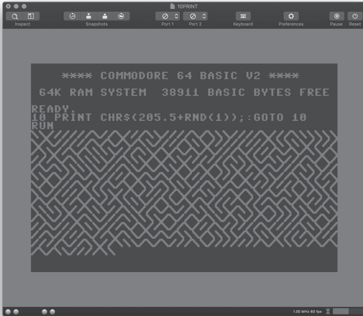
図 1 「10 PRINT」プログラムを VirtualC64（Commodore 64 のエミュレータ）上で実行している様子
